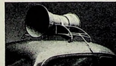
Kreuzstrahler für 60 W mit praktischer Wagendachbefestigung
